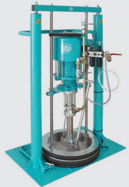
Pumpeinheit mit Zweisäulenheber für 200 Liter-Fässer. Zur Förderung höchstviskoser Materialien bieten wir Ihnen auch Rammpressen mit besonders großem Zylinderdurchmesser.
