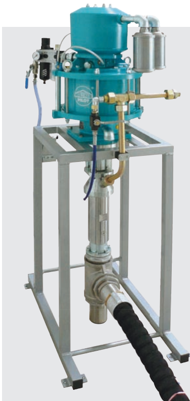
Anlage für Automatik-, Hand- bzw. Tippbetrieb. Zweihandbedienung für optimalen Sicherheitskomfort. Füllstandsmesstechnik integrierbar. Folgeplattenbeheizung auf Anfrage.
